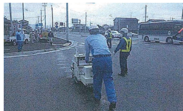
スーパーコーディエンス法による埋設管腐食検査
